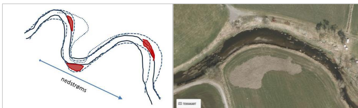
Figur 4.9: T.v.: En meanderende elvestrekning er utsatt for erosjon spesielt i yttersvingene (røde felt) i det opprinnelige elveløpet (heltrukken linje) (Skarbøvik og Blankenberg, 2013). Over tid kan erosjon danne nytt elveløp (stiplet og prikket linje). Flyfotoet viser en meanderende sving i Nedre Tverråna, hvor erosjon og sedimentering er tydelig ( www.temakart-rogaland.no ).
