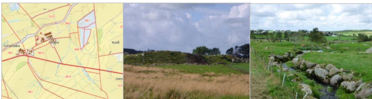
Figur 6.50: T.v.: Lendekanalene går på vestsiden av Fotland. Midten: En fylling og deponi. T.h.: Vannet fra beiteområdet går gjennom veieablerte renseparker.
